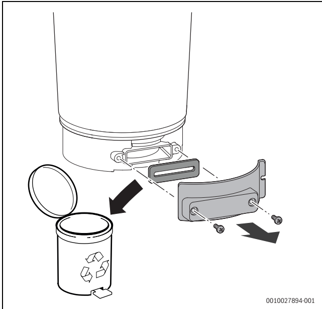
Мал. 123 Відкриття контрольно-ревізійного отвору
